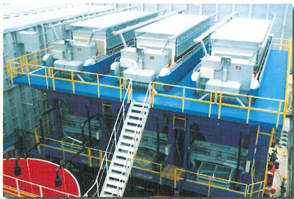
泥水シールド余剰泥水処理 高压薄层フィルタープレス 2,000 × (10.9m³) × 3台
