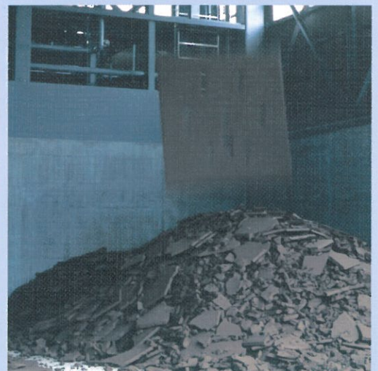
脱水ケーキ（落下方式）
