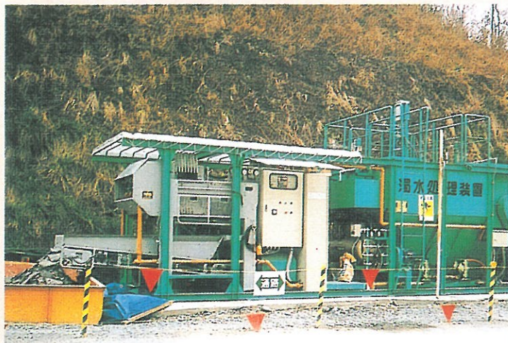
HFS-20型 原水濁度3,000ppm処理量20m³/H
