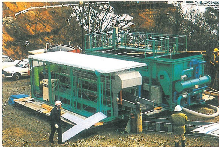
HFS-60型 原水濁度6,000ppm処理量60 m /H
